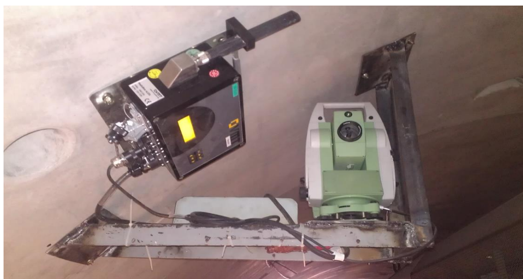
4-расм: Ярим роботлаштирилган лазерли тахеометр ва силжувчи радиомодем.
