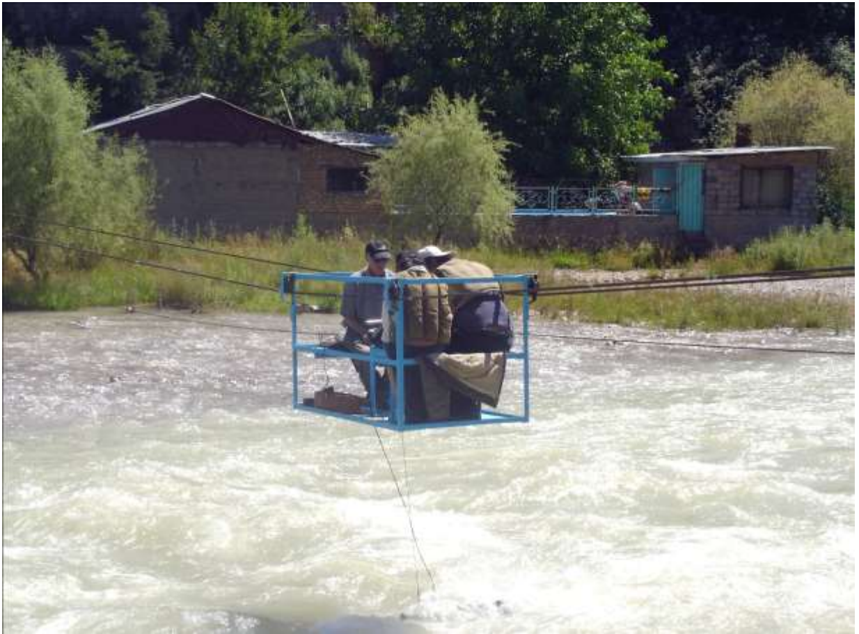
Рис. 4.3. Измерение расхода воды на реке Угам
