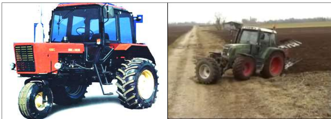
3.2-расм. Энг кичик бурилиш радиусига эга бўлган 2X3 схемали (а) ва махсус ғилдиракли қурилма ўрнатилган 4X4 схемали (б) тракторлар
