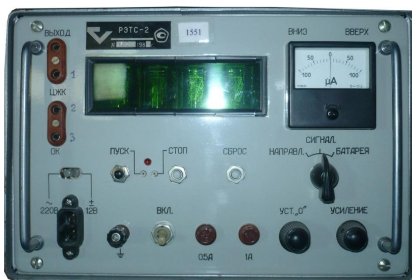
15- расм. РЭТС-2 расходомерия ўлчовларини ер усти бошқариши
