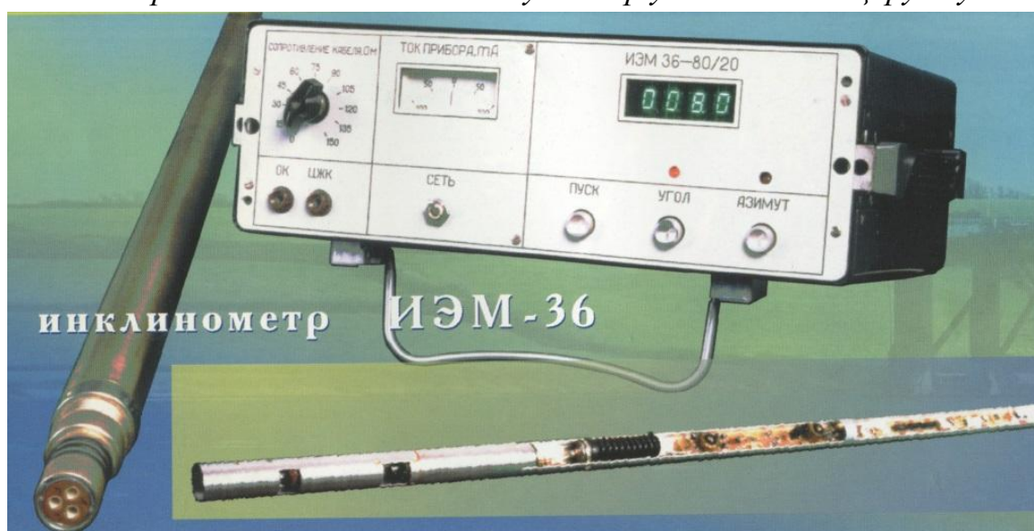
3 - расм. ИЭМ-36 асбоби ва унинг ер устидаги бошқарув пулти
