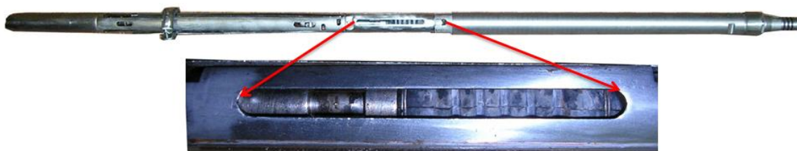
8 - расмда КМ- кавернометрининг ташқи тузилиш схемаси
