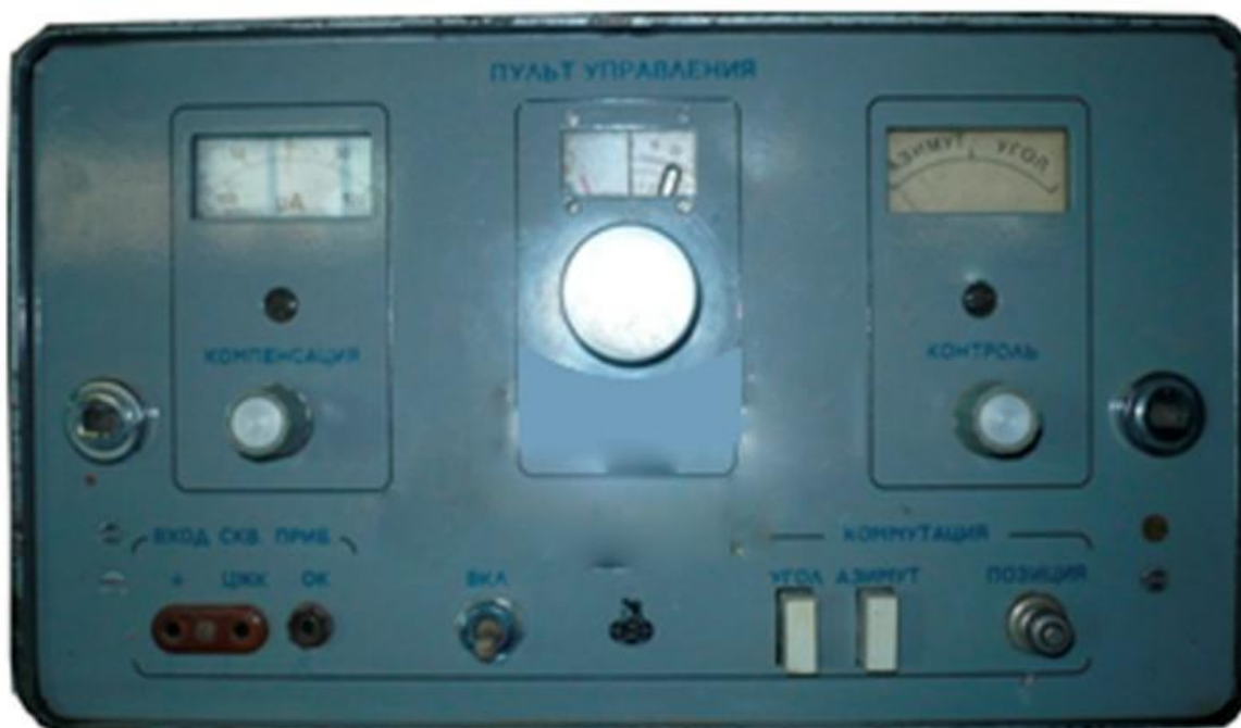
1-расм. КИТ - 60 қудуқ зонди ва КИТ-60 асбоби ва унинг ер устидаги бошқарув пулти
