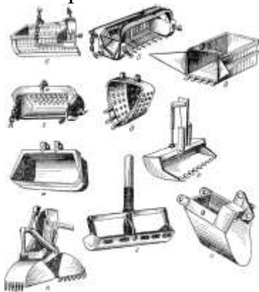
5.8-расм. Коллекторларни тозалаш учун қўлланиладиган экскаваторларнинг махсус чўмичлари.
