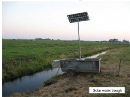
Quyosh energiyasida ishlaydigan suv ohuri
