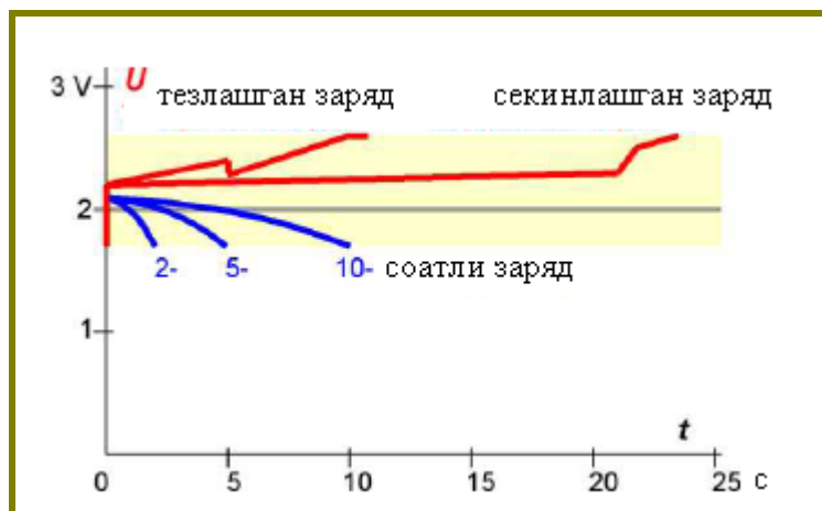
4.14- расм. Қўрғошинли аккумуляторни кучланишини турли заряд ва разрядда ўлчаш.
