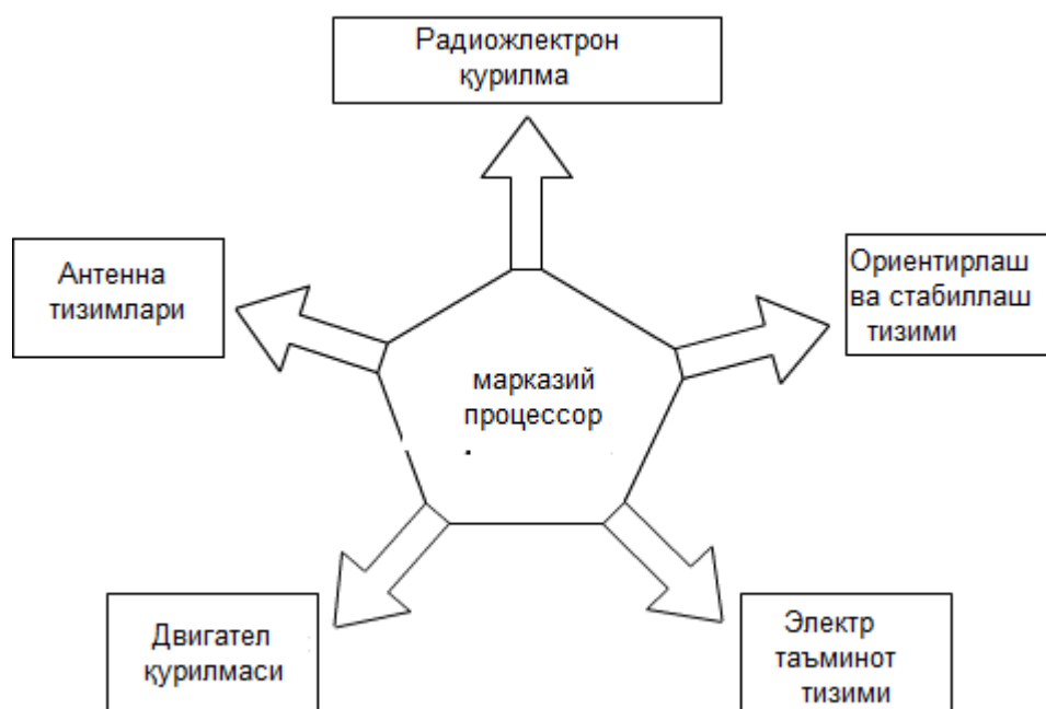
2.16- расм. Йўлдош-ретрансляторнинг умумий тузилиш схемаси.
