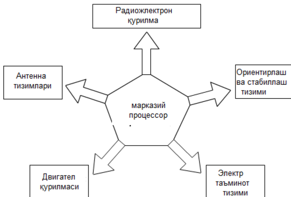
2.16- расм. Йўлдош-ретрансляторнинг умумий тузилиш схемаси.
