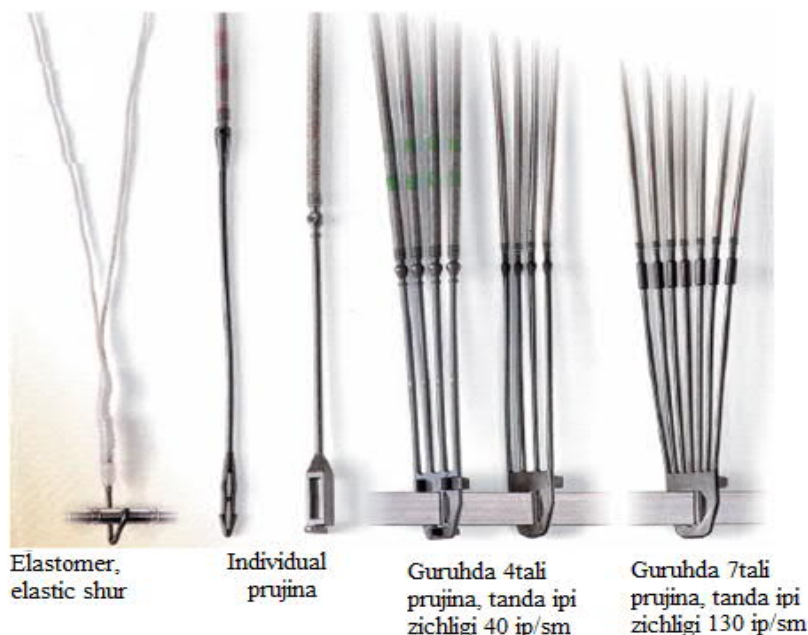
36-rasm. Tanda iplarini pastga tushirish elementlari
