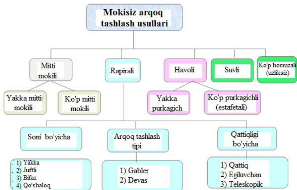
1-rasm. Mokisiz arqoq tashlash usullari
