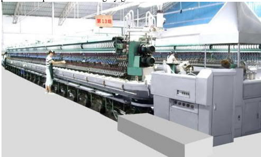
6.1-rasm. FY2008 pilla chuvish avtomatining umumiy ko'rinishi
