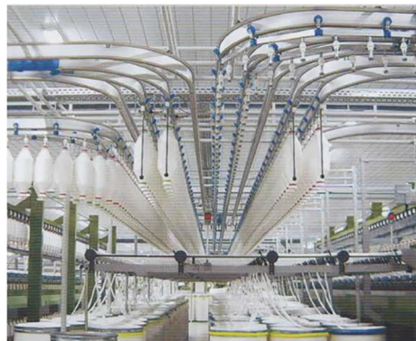
4.11-rasm. Pilikli g'altaklar uchun osma relslar
