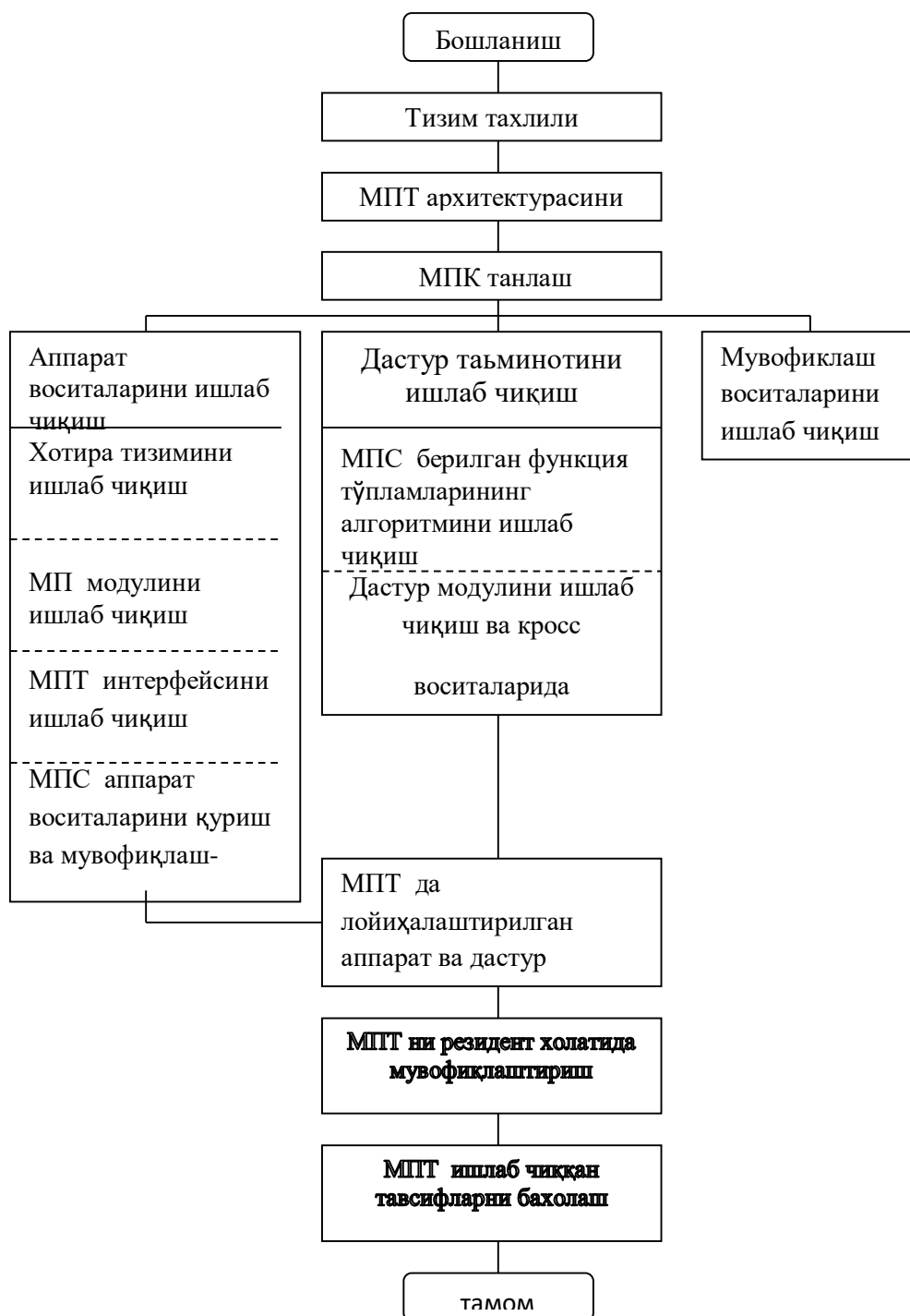
1.1-расм.МП базасида қурилмаларни лойиҳалаштиришнинг асосий босқичлари
