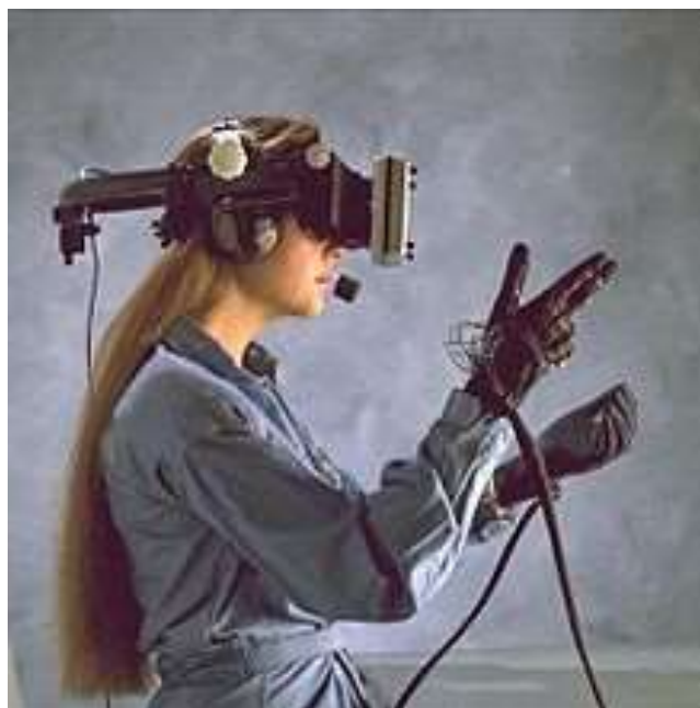
4.2-расм. Виртуал реаллик перчаткалари.
