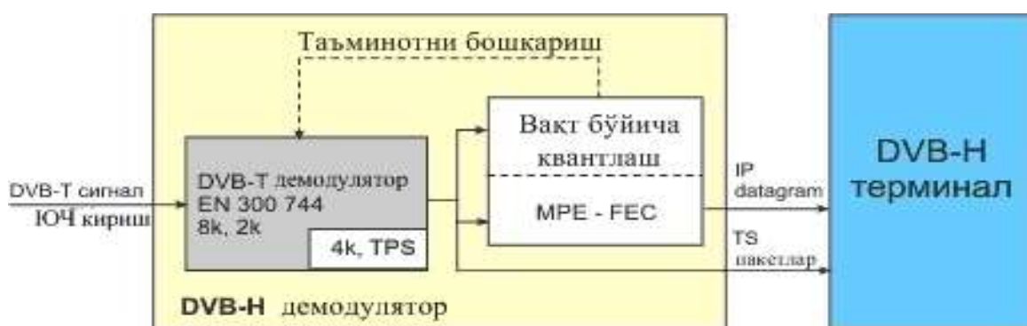
4.11.расм. DVB-H қабул қилгичнинг концептуал тузилиши
