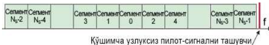
5.20-расм. Узатилаётган радиосигнал спектри ( N_s -сегментлар миқдори)
