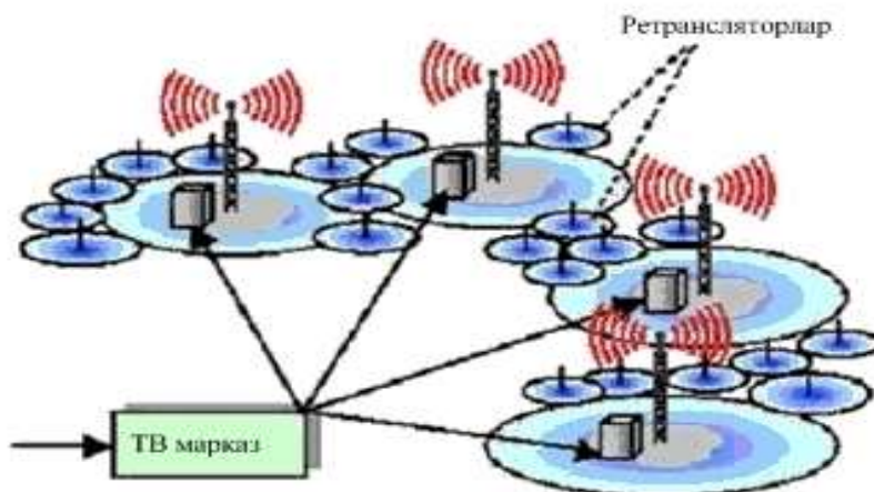
4.12-расм. DVB-H бир частотали тармоқ варианты
