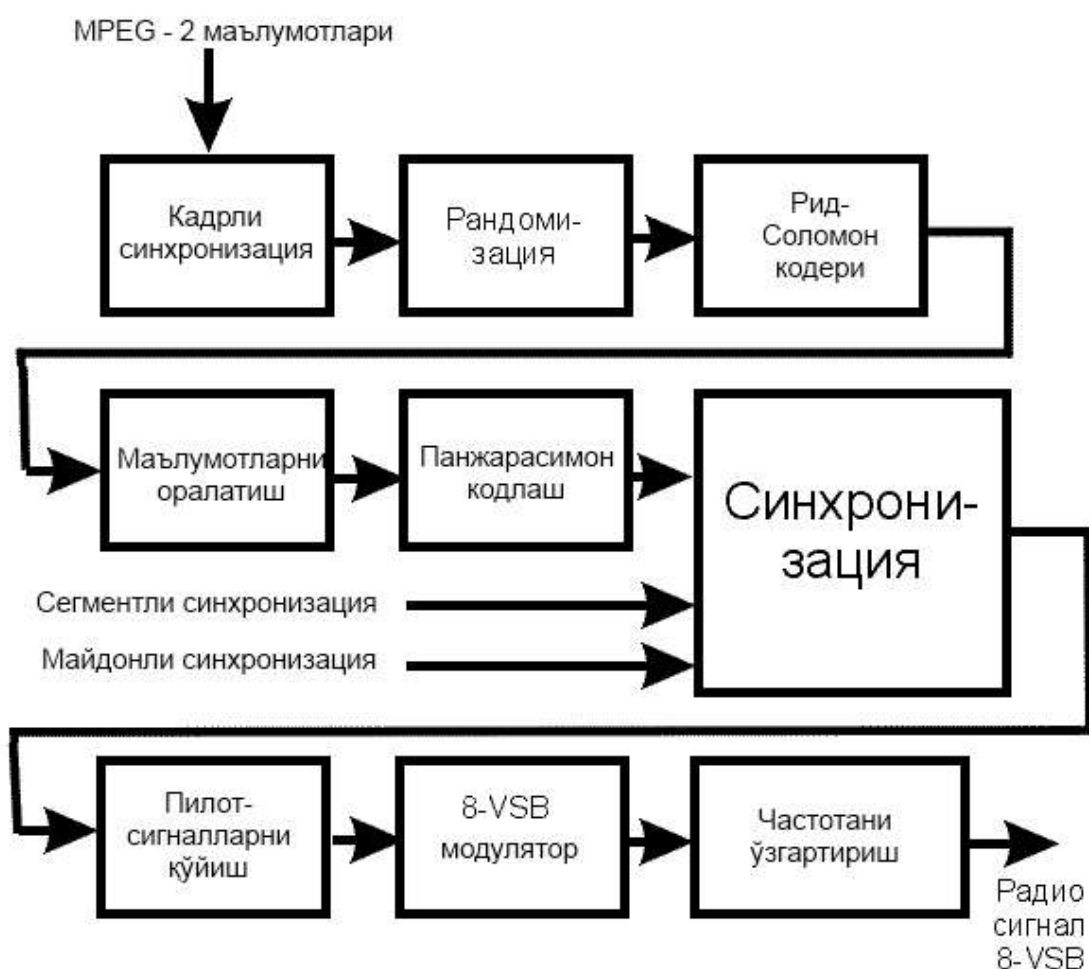
5.15-расм. ATSC тизимининг узатувчи қисми тузилиши.
