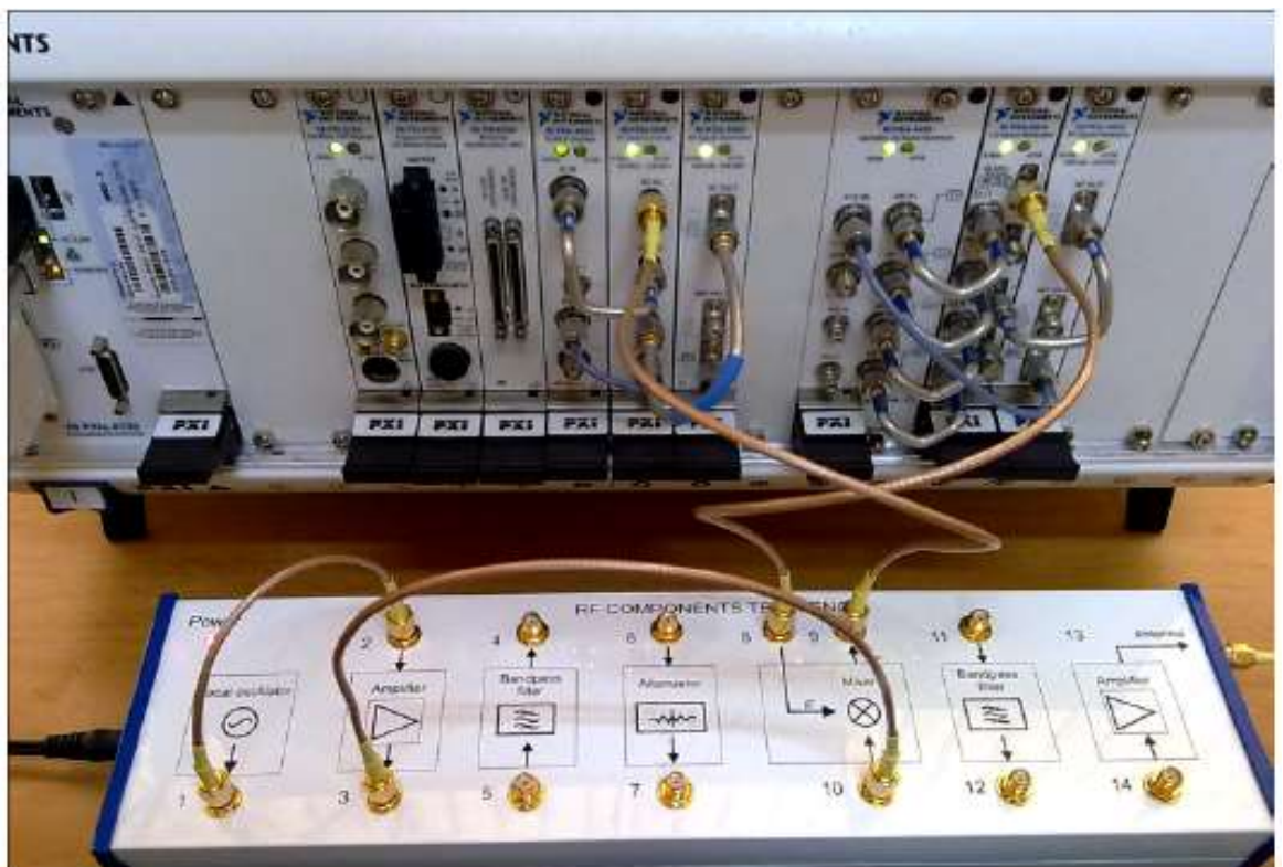
3 расм. Амалий ишнинг бажарилишидаги тизим уланиш схемаси.
