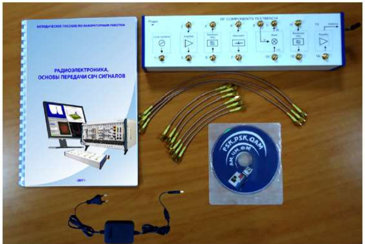
2-расм. “RF Components Test bench” стенди элементлари.
