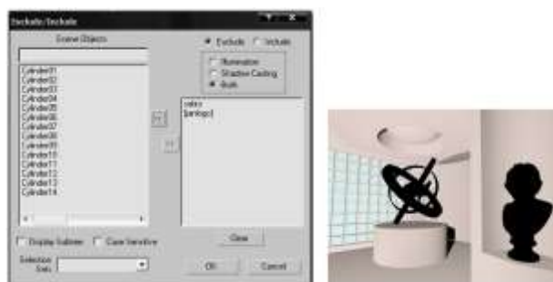
1.38-расм. Чапда: Exclude/Include ойнаси параметрлари; Ўнгда: ёруғлик манбасидан сахнадаги иккита объектни чиқариш натижаси.
