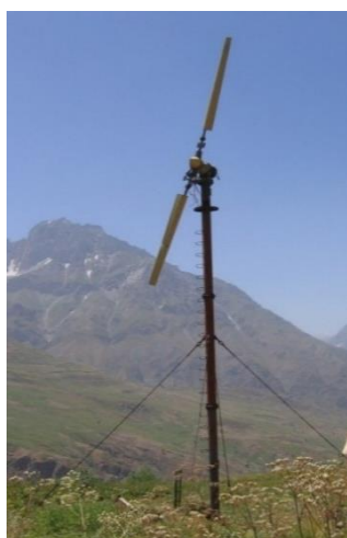
4.5-расм. Қанотли шамол ғилдирақларининг кўриниши: а-икки ғилдирақли; б-уч ғилдирақли; в-тўрт ғилдирақли
