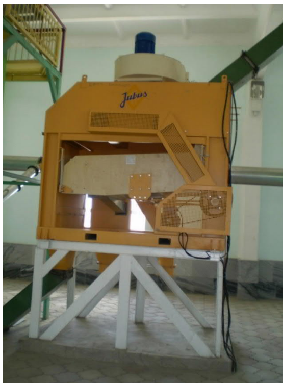
3-расм. L-JS-4 туксизлантирилган чигит тозалаш-саралаш машинасининг умумий кўриниши
