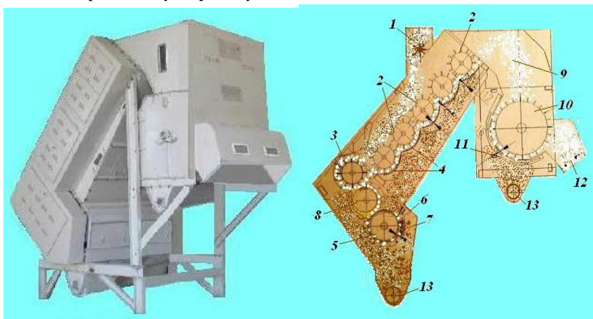
10-расм. MQZK-2400 русумли пахта тозалагичнинг кўндаланг қирқими
