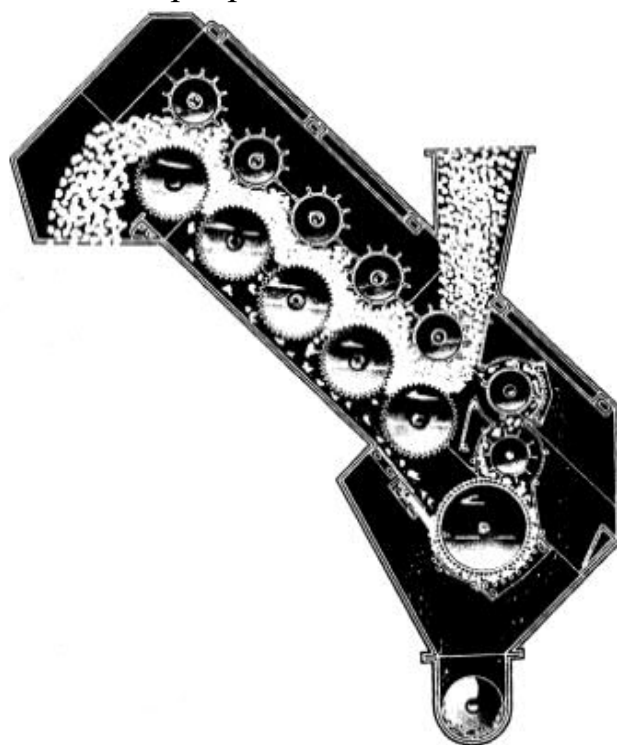
7-расм. “Continental Eagle” корпорациясининг қозикчали-аррачали барабанли қия тозалагич схемаси
