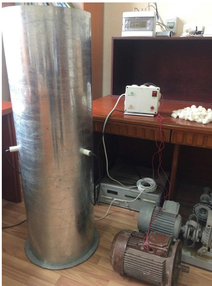
3.7-расм. Ёнғинни автоматик аниқлаш қурилмасининг стенд нусхаси.
