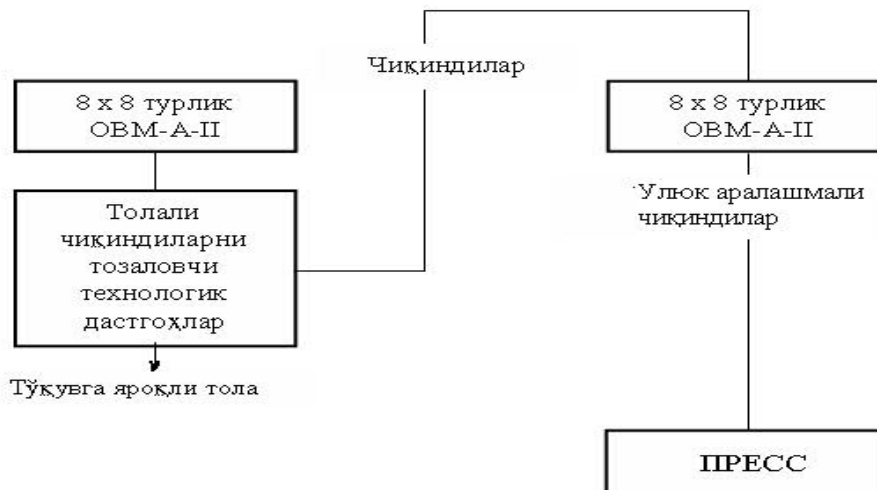
15-расм. Толали чиқиндиларни тозалашнинг технологик схемаси
