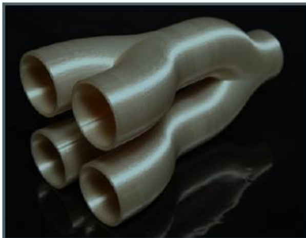
4.1.3-расм. FDM печать усулида 3D-принтерда печать қилинган модель
