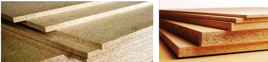
5.9-расм. Қопланмаган ва қопланган ёғоч қириндили плиталар
