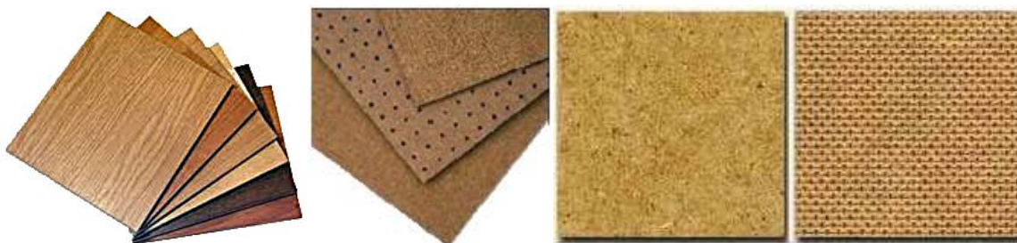
5.11-расм. Ёғоч толалали плиталар
