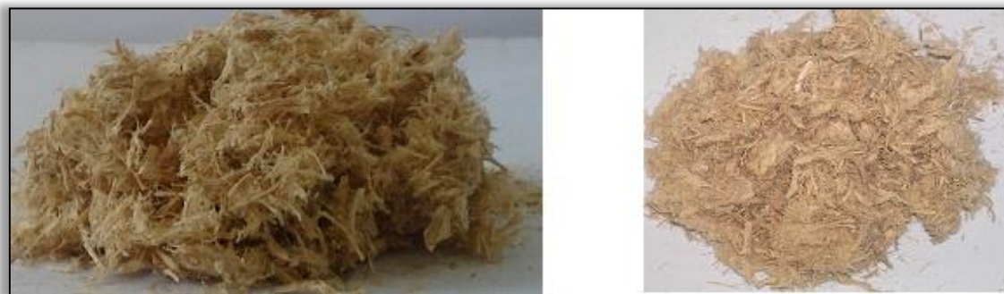
4.13-расм. Иккинчи босқичдан кейин олинган ярим тайёр целлюлоза намунасининг умумий кўриниши.
