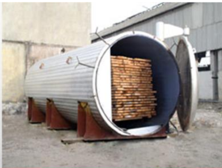
Термоёғоч олиш учун махсус герметик камера
