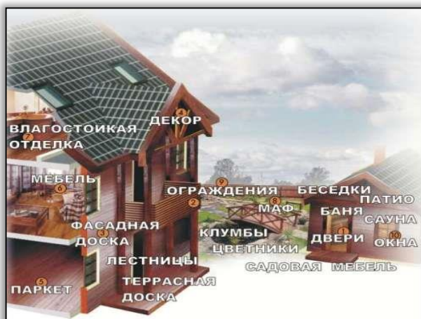
3.3-расм. Термоёғочнинг бинонинг турли конструкцияларида ишлатилиши
