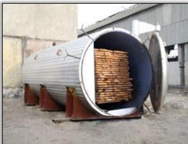
3.1-расм. Термоёғоч олиш учун махсус герметик камера
