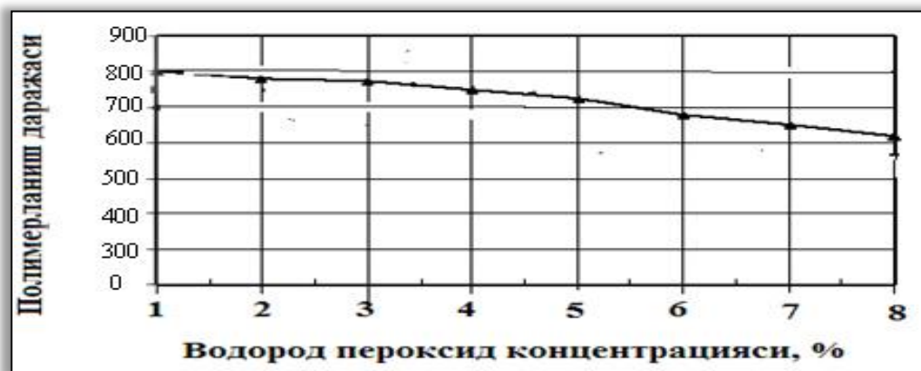
4.8-расм. Целлюлозанинг полимерланиш даражасига водород пероксид концентрациясининг таъсири.
