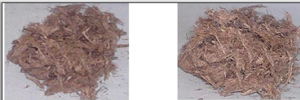
4.12-расм. Биринчи босқич оқартиришдан кейинги ярим тайёр целлюлозанинг умумий кўриниши.
