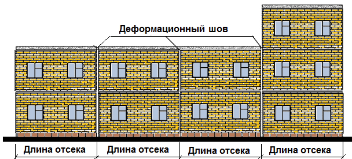
Рис. 1.25. Деление здания вертикальными деформационными швами на отсеки
