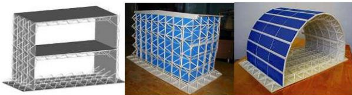
Рис. 3.14. Примеры многосвязных зданий замкнутого типа, объединенных с пространственной фундаментной платформой
