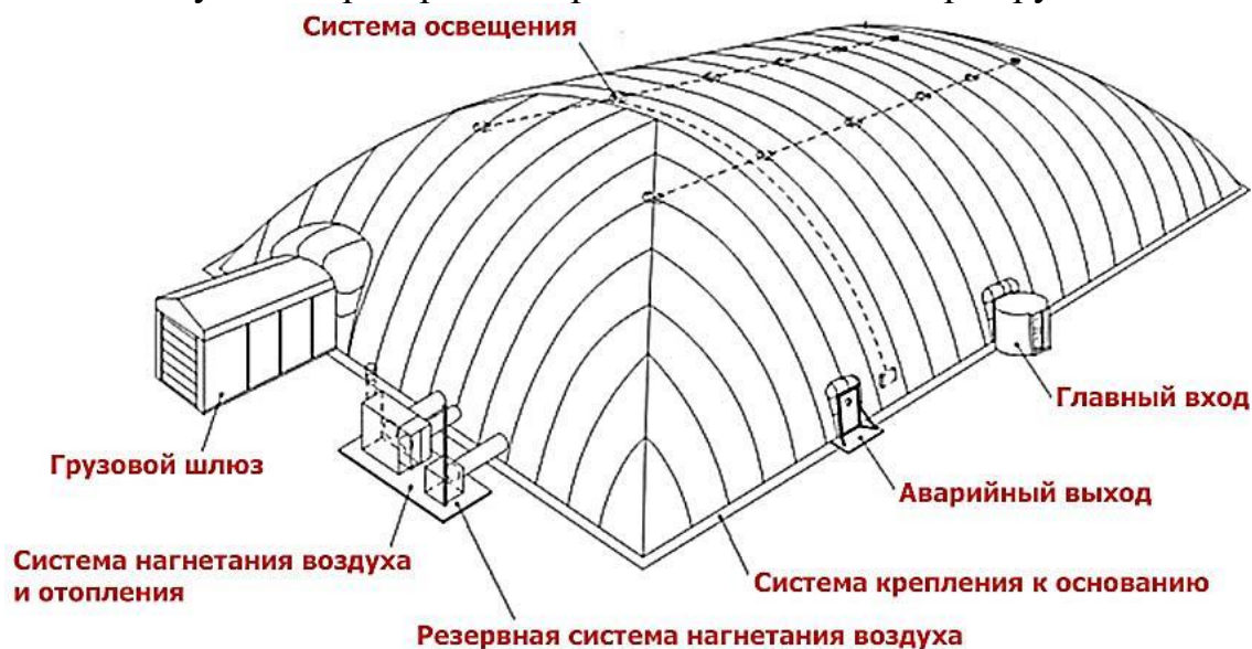
Рис. 2.51. Устройство пневматического воздухоопорного покрытия
