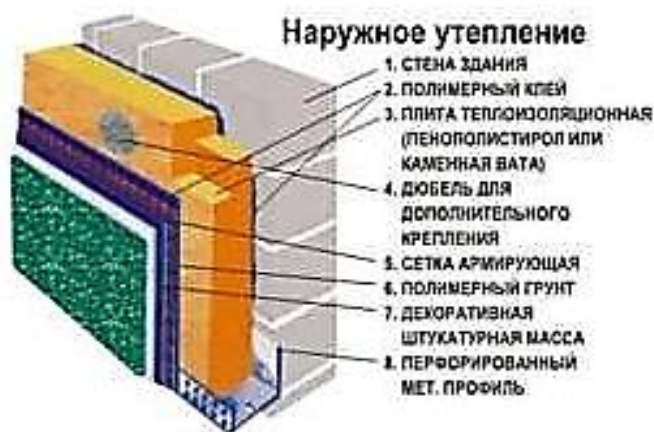
Рис.Пр2.1. Конструкция многослойной стены
