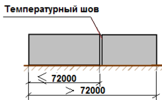
Рис. 1.29. Температурный шов в здании с железобетонным каркасом
