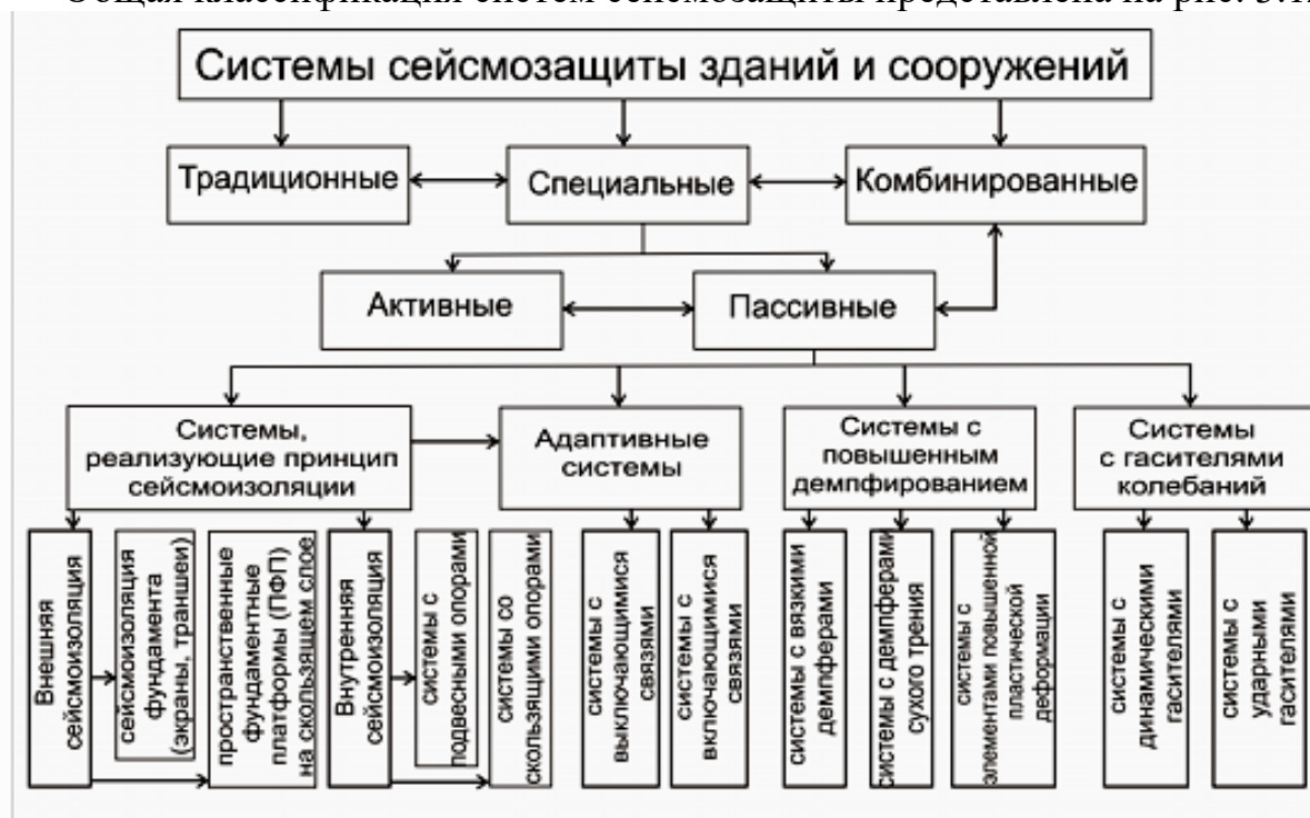
Рис. 3.12. Классификация систем сейсмозащиты по принципу их работы
