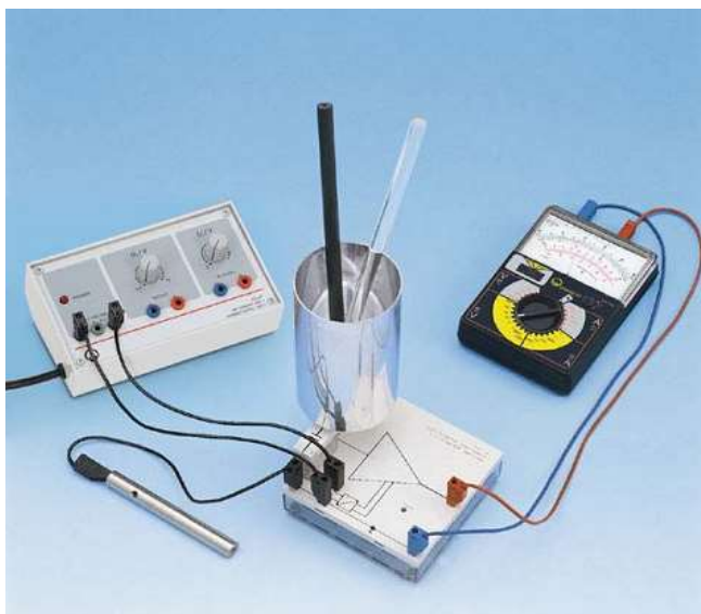
1 - расм. 450 В ли ток манбаили тажриба қурилмаси.
