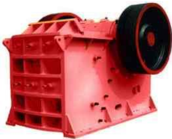
6–расм. СМД-117А русумли 2100×1500 мм ўлчамли оддий ҳаракатланувчи жағли майдалагич.
