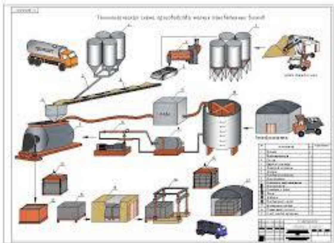
Кўпик-бетонли блоklar ишлаб чиқариш технологик схемаси
