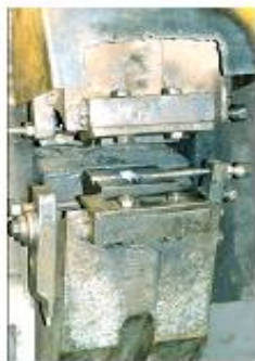
1.12-расм. а-диаметри 10-12 мм таранглаштирилувчи арматура стерженларида сиқиб анкер ҳосил қилувчи пневматик ускуна; б-шайбадан ясалган анкерли таранглаштирилувчи арматура стержени.
