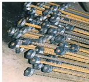
1.12-расм. а-диаметри 10-12 мм таранглаштирилувчи арматура стерженларида сиқиб анкер ҳосил қилувчи пневматик ускуна; б-шайбадан ясалган анкерли таранглаштирилувчи арматура стержени.
