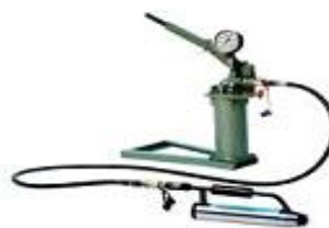
4 шлангли 160 кН кучга эга гидравлик домкрат гидравлик агрегати билан
