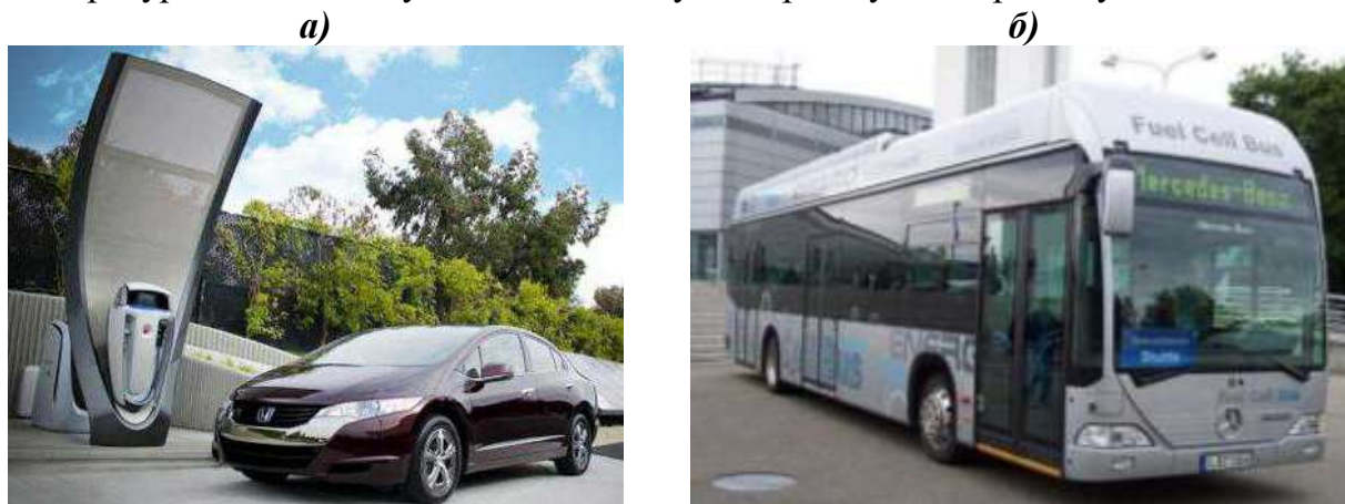
57-расм. Водород ёқилғисидида ишлайдиган Honda FCX енгил автомобили ва ёқилғи қўйиш станцияси (а) ҳамда Citaro автобуси (б)
