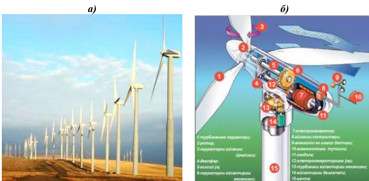
27-расм. Саноатда ишлаб чиқариладиган шамол энергетик қурилмаларининг жойлашиши (а) ва тузилиши(б):
