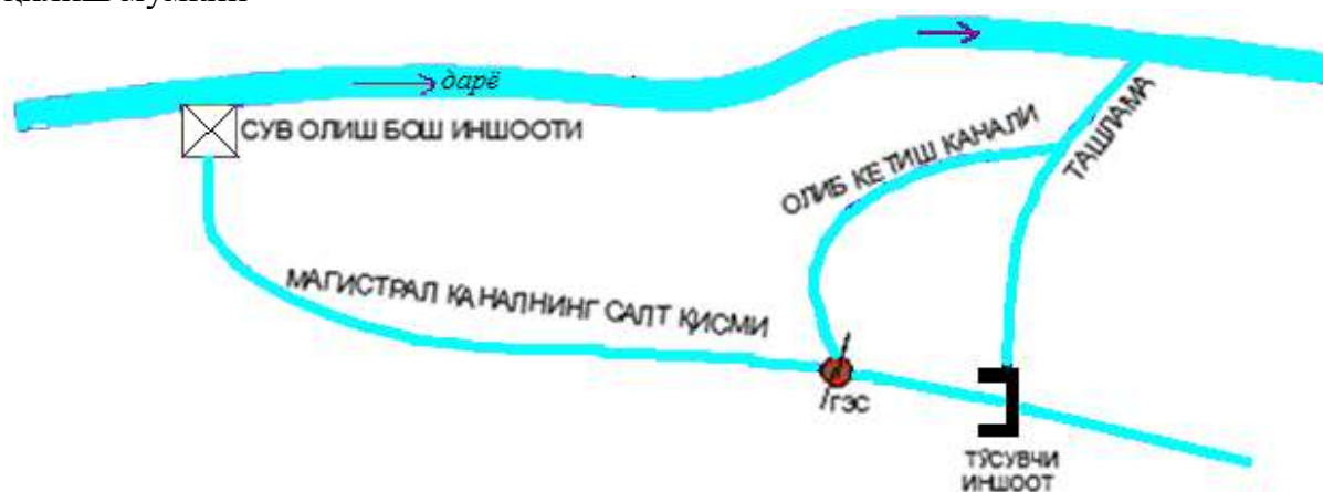
26-расм. Магистрал каналнинг нишаблиги дарё нишаблигидан кичик бўлган ( I_{\text{маг.канал}} < I_{\text{дарё}} ) ҳолатда энергия ишлаб чиқариш схемаси.
