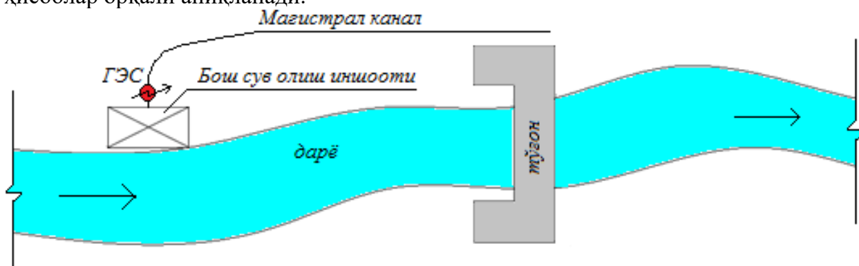
32-расм. Бош сув олиш иншоотидаги ГЭСнинг схемаси.
