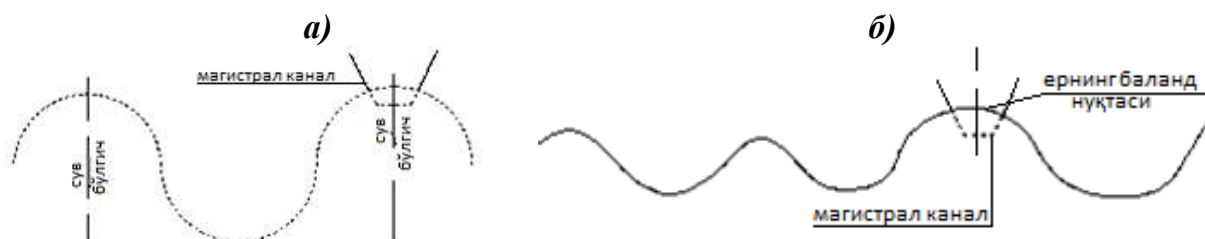
48-расм. Сув бўлиш чўққиларидан (а) ва ернинг баланд нуқталаридан (б) ўтказилган суғориш тармоқлари.
