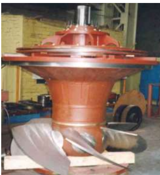
54 - расм. Парракли турбина роторининг йиғилган ҳолатдаги кўриниши.
