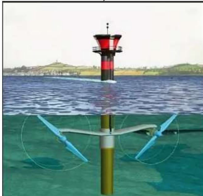
21-расм. Эркин оқим ҳамда океан ва денгизларнинг ички оқимларида ишлайдиган микроГЭСлар
