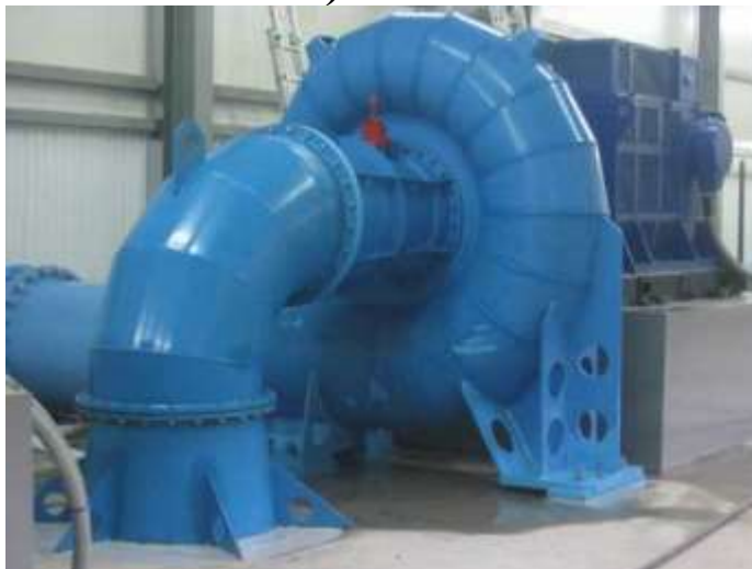
55-расм. Тўғри ўкли конуссимон (а) ва тирсаксимон (б) сўриб кетиш қувурли парракли гидроагрегатлар.
