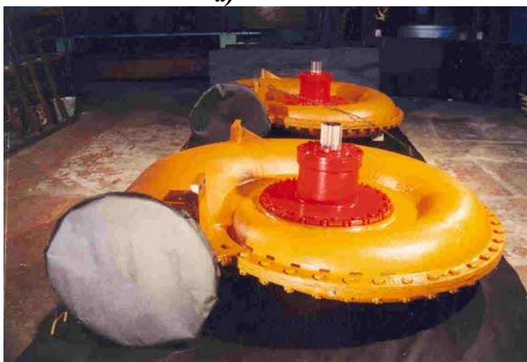
58-расм. Вертикал(а) ва горизонтал (б) ўрнатиладиган радиал-ўқий турбиналар.
