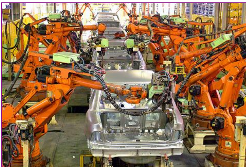
3-rasm. Avtomobil organlarining ommaviy-ishlab chiqarish liniyasi
