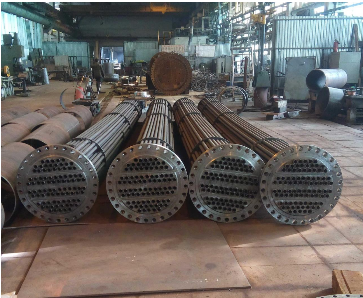
5-расм. Кўп йўлли иссиқлик алмашиниш қурилмаси (қувур бўшлиғи бўйича). 1-қобик; 2-иситувчи қувур; 3-қопқоқ; 4-тўсиқ.
