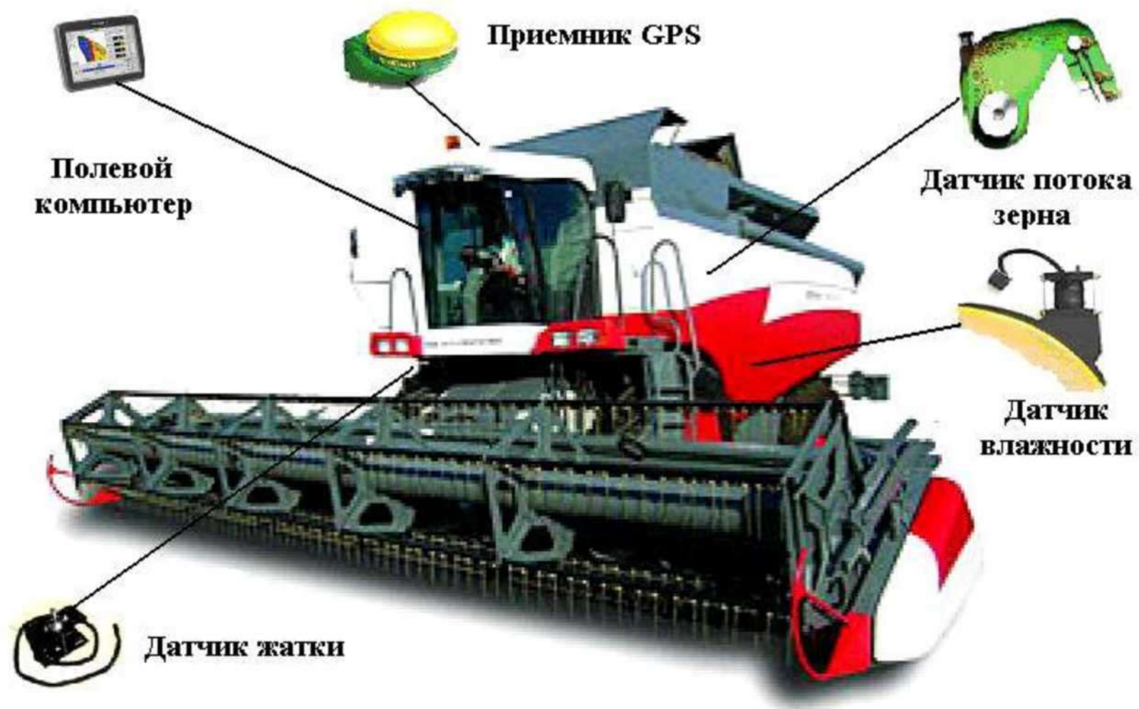
2-расм. Ҳосилдорликни мониторинглаш тизими жихозларининг ғалла комбайнида жойлашиши
