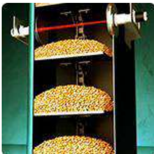
10-расм. Дон миқдорини ҳажм бўйича аниқлаш датчиги
