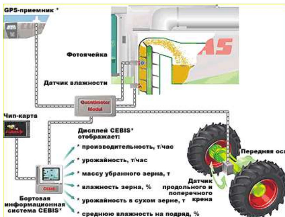
6-расм. Ҳосилдорликни мониторинглаш тизими қурилмаси элементлари схемаси
