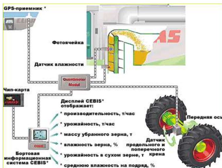
6-расм. Ҳосилдорликни мониторинглаш тизими элементлари схемаси
