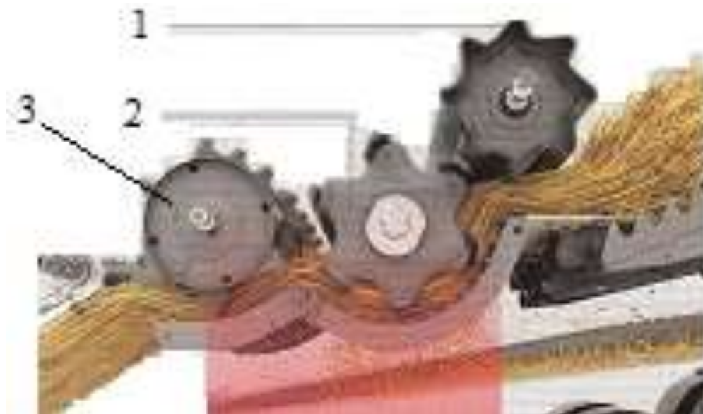
67-расм. “Доминатор-130” комбайнининг янчиш аппарати 1-қайтарувчи битер; 2-янчиш барабани; 3- тезлатгич барабан.
