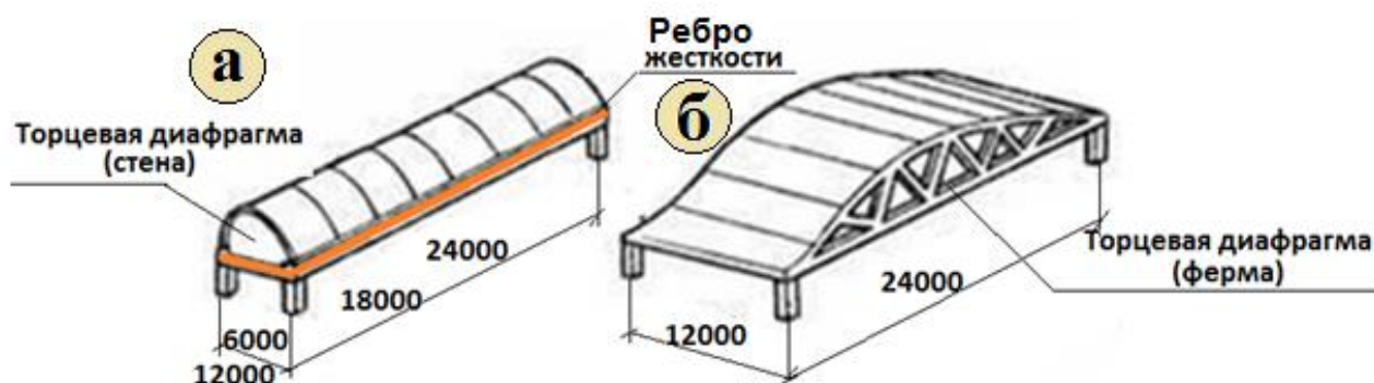
Рис.2.37. Цилиндрические оболочки одинарной кривизны: а – длинная; б – короткая
