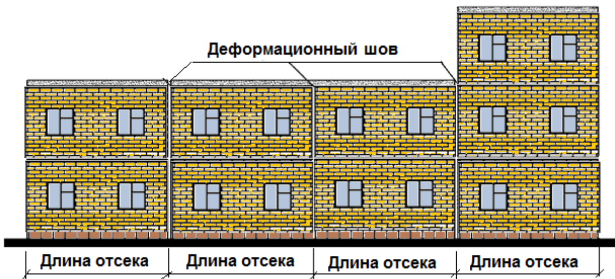
Рис. 1.25. Деление здания вертикальными деформационными швами на отсеки
