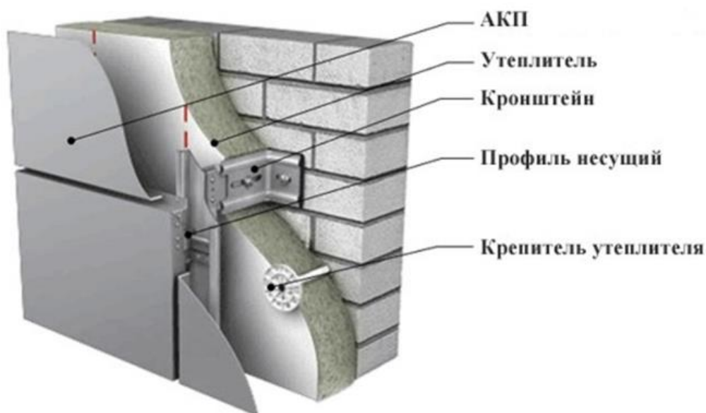
Рис. Пр2.2. Устройство вентилируемой прослойки в стене
