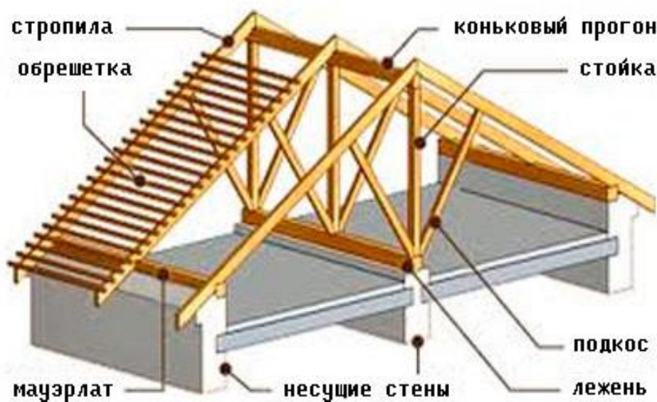
Рис. Пр1.22. Покрытие по наслонным стропилам
