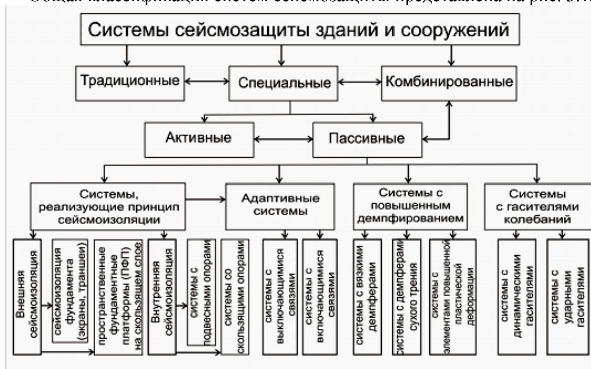
Рис. 3.12. Классификация систем сейсмозащиты по принципу их работы
