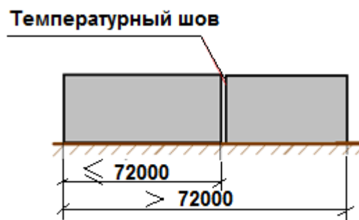
Рис. 1.29. Температурный шов в здании с железобетонным каркасом
