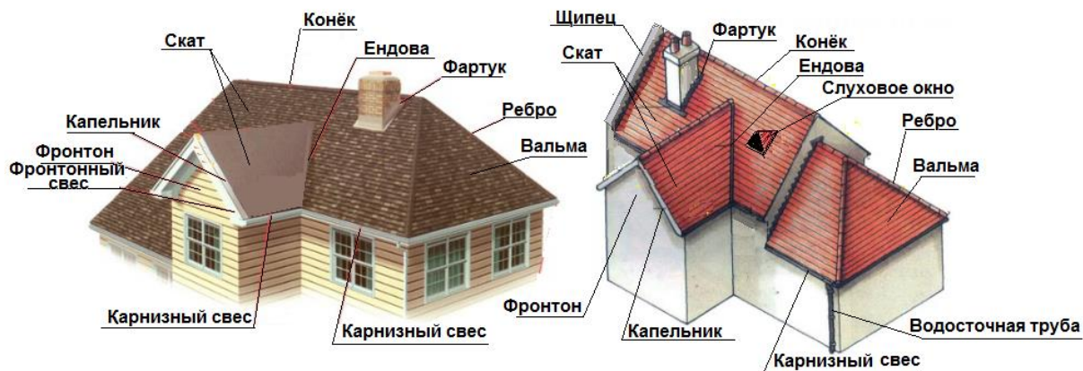
Рис. Пр1.21. Элементы кровли стропильной крыши
