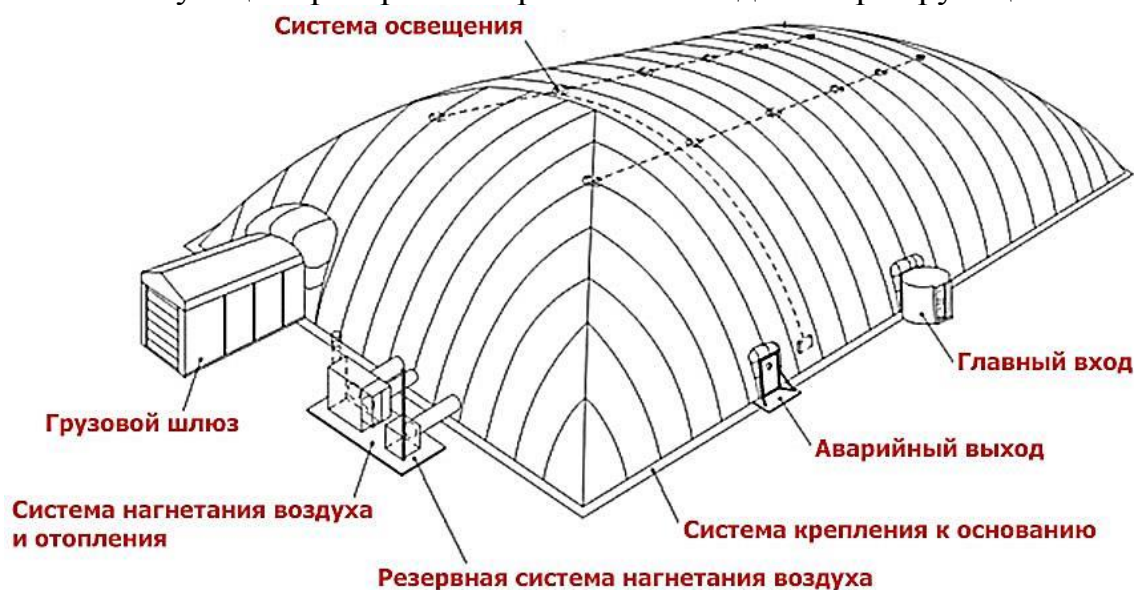
Рис. 2.51. Устройство пневматического воздухоопорного покрытия
