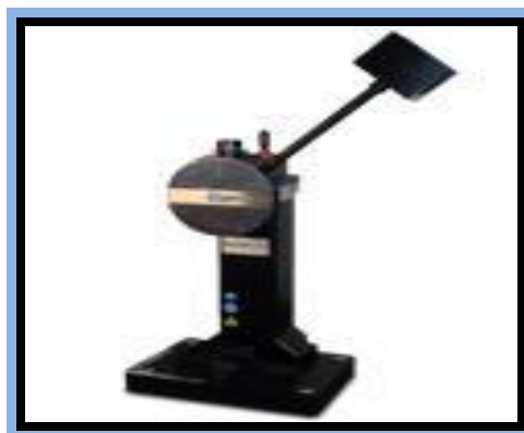
2.1-расм. “Маятникли копёр” материалларни зарбий қовушоқлигини аниқлашда ишлатиладиган қурилма
