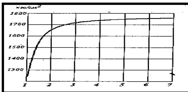
3.5-расм. Кукун материалларни боғловчи моддалар билан аралаштириш вақтини материалнинг сиқилишдаги механик мустаҳкамлигига таъсир диаграммаси
