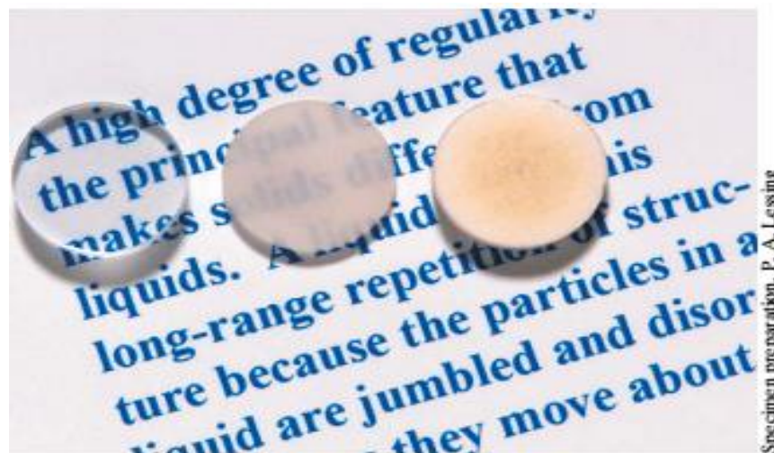
Расм. 1.2. Алюмин оксиддан тайёрланган учта ингичка дисклар сурати
