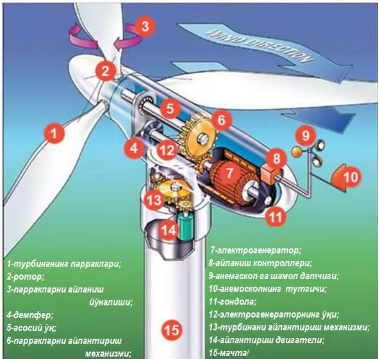
52-расм. Шамол энергоқурилмаларининг тузилиши.
