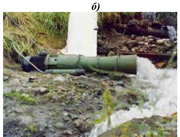
3.4-расм. МикроГЭС 10 Прнинг металл қувурлар ( a ) ва брезентли қувурлар ( б ) билан улаб эксплуатация қилиш ҳолатлари.
