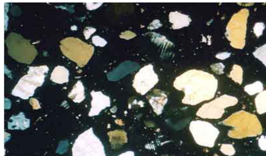
8-Расм Б . Цемент плиткани микрорасмлари – қора рангдаги асосий масса – магнезиал цемент, йирик донали оқ рангли заррачалар – дала шпатлари, слюдалар таркибида тутган қум минераллари. катталаштириш даражаси 25^{\times} . Ўтқазувчи нур, николлар кесишга холда.
