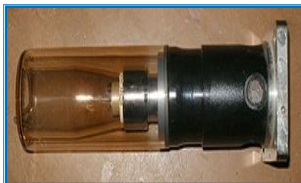
17 расм. ДРОН-7 рентген дифрактометри ва рентген трубкаси.
