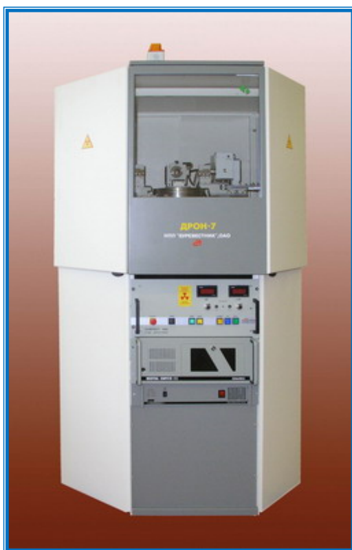
17 расм. ДРОН-7 рентген дифрактометри ва рентген трубкаси.
