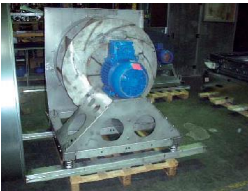
3.32-расм. Вентилятор – бўш ғилдирак d = 250 \dots 1250 мм
