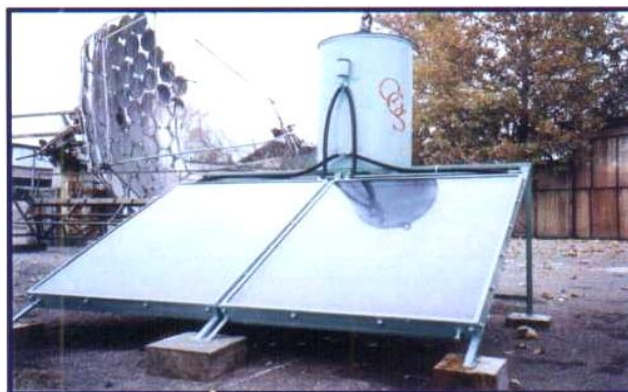
1.2.13-расм. Қуёш иситгичининг сатҳи 4 \text{ м}^2 ва иссиқ сув жамловчи бакининг ҳажми 300 л бўлган 2 контурли сув иситгич қурилма
