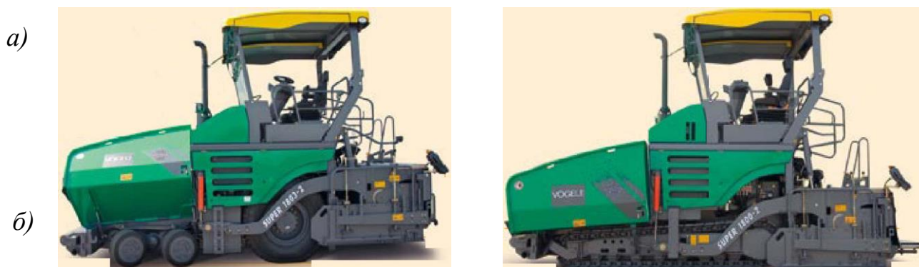
20-расм. Хозирги замон асфальтобетон қоришмасини йўлга ётқизувчи машиналар: а) резина ғилдиракли; б) гусеничали.
