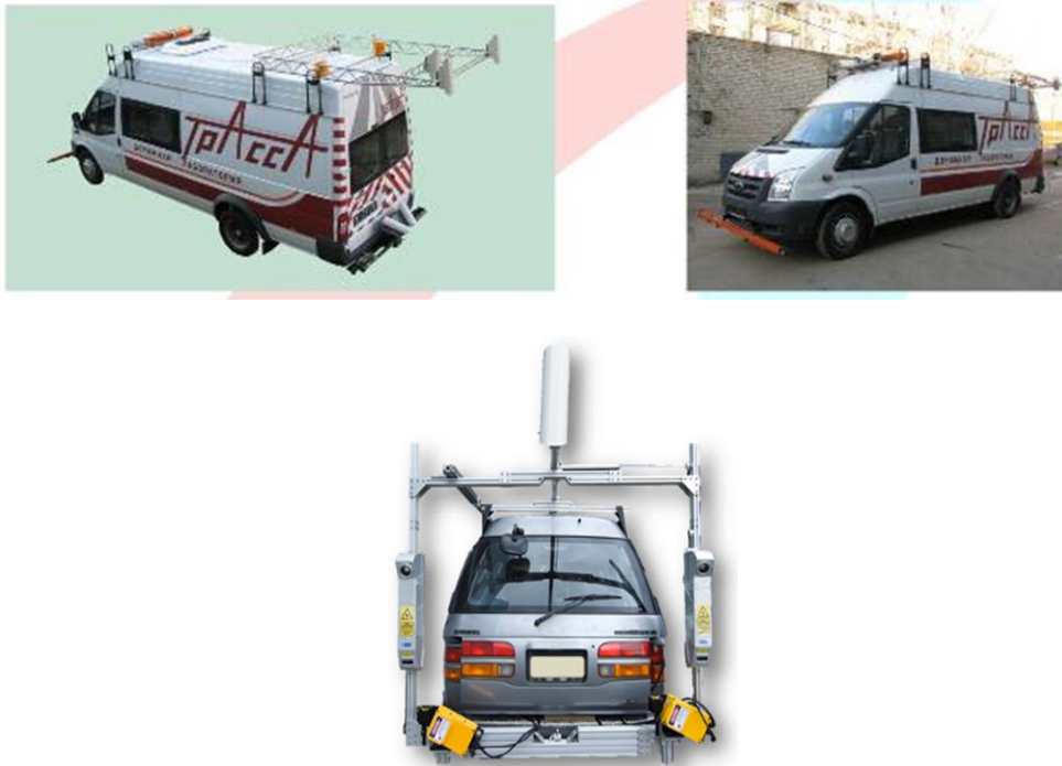
5-расм. Автомобиль йўлларини диагностикасини амалга оширувчи ихтисослаштирилган кўчма лабораториялар
