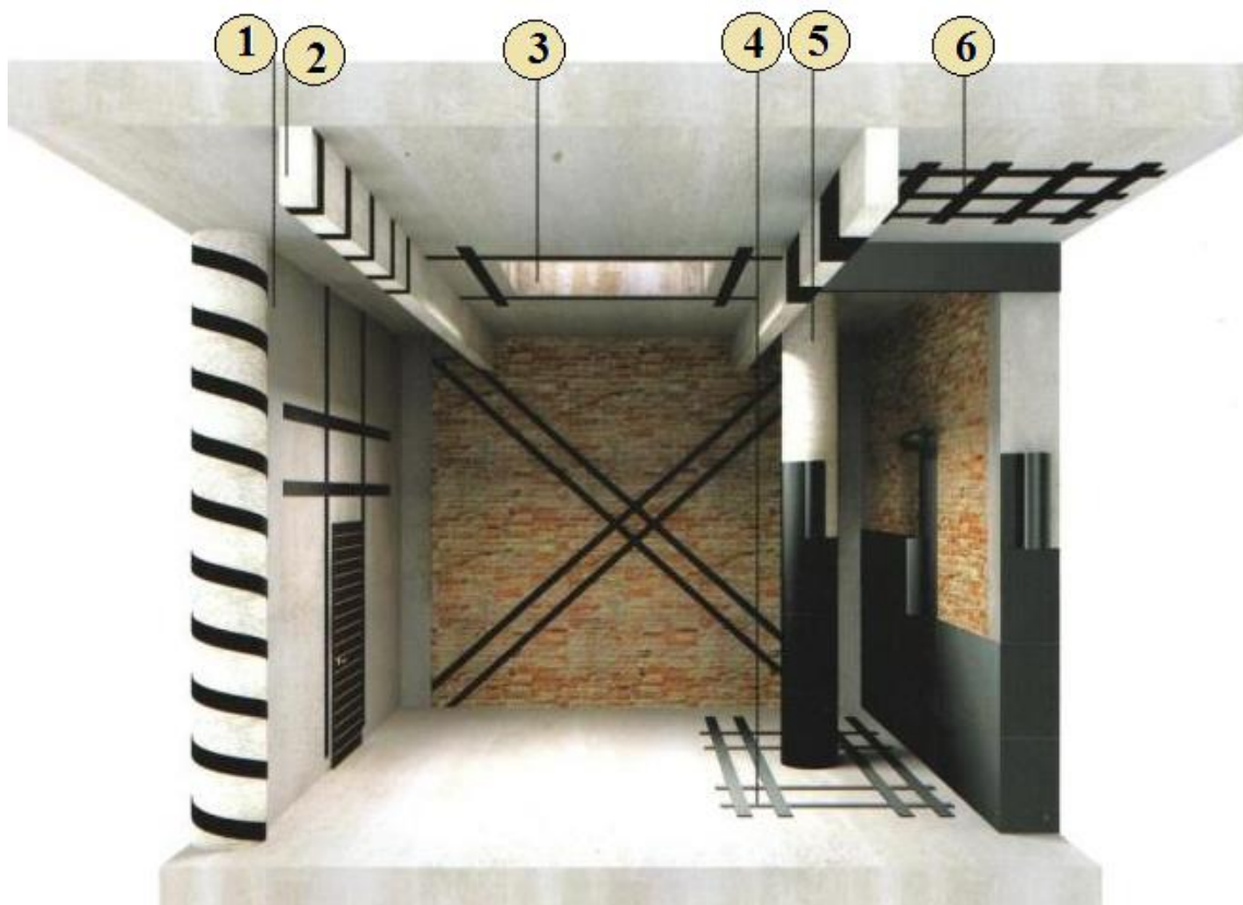
Рис.Пр4.9. Усиление железобетонных конструкций при помощи углепластиковых лент: 1 – стены; 2- балки; 3 – потолочные проёмы; 4 – полы из природного камня; 5 – опоры; 6 - потолки
