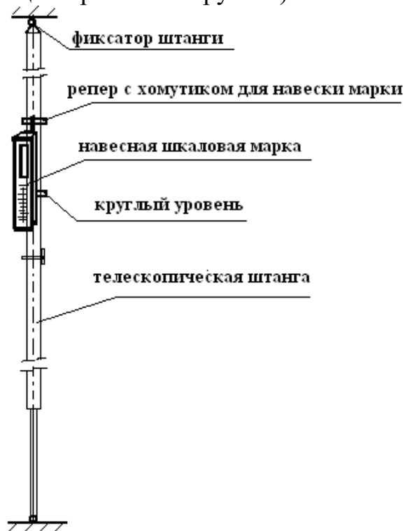
Рис. Пр1.5. Вид телескопической штанги при определении прогибов ПОТОЛКОВ
