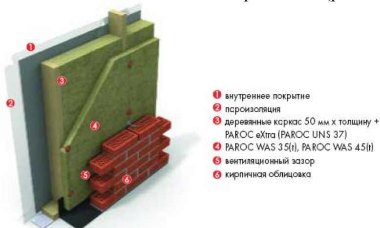
Рис. 4.6. Каркасная конструкция с кирпичной облицовкой
