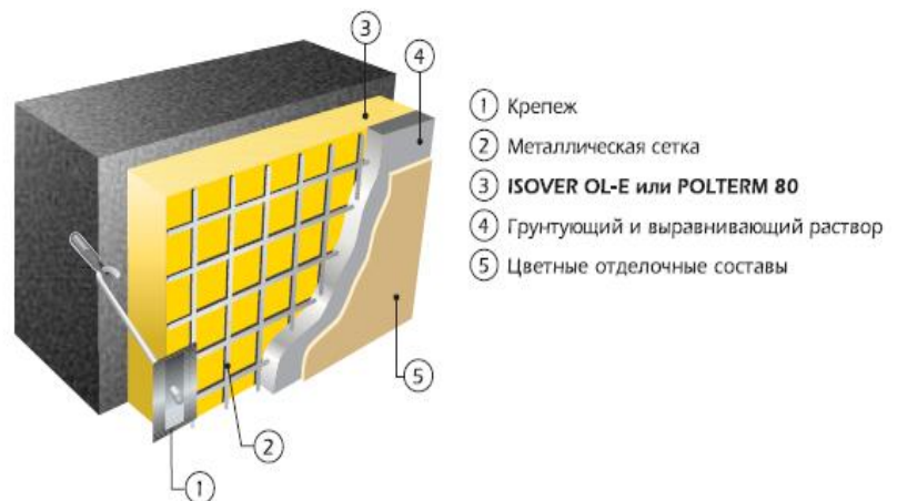
Рис. 4.4. Утепление фасада теплоизоляционной системой с толстослойной штукатуркой
