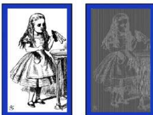
1.12-расм. ECB режимининг заифлиги
