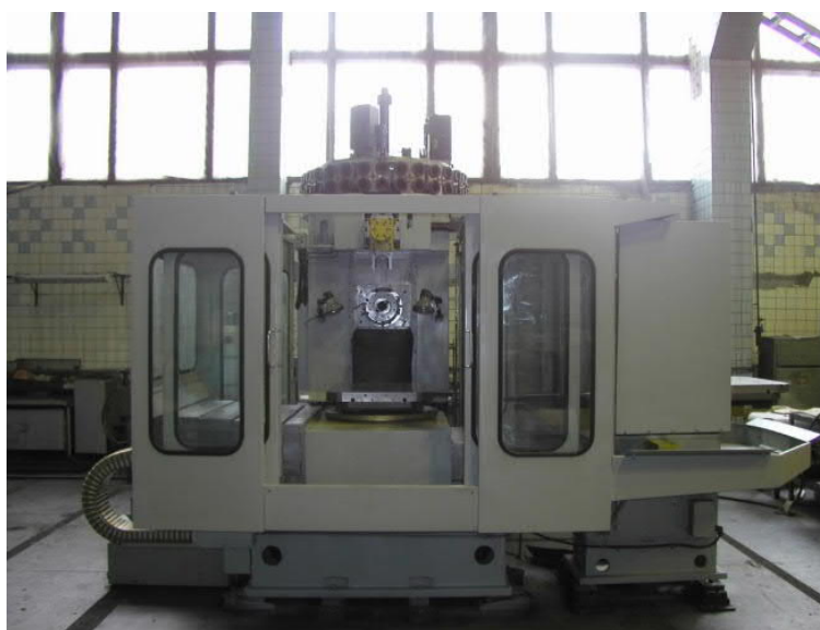
8-расм Горизонтал вазифали дастгоҳ – модель ГДФ630.
