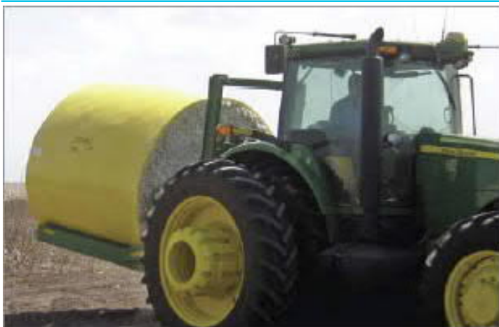
11. Расм. Цилиндр шаклдаги пахта модулини далада ташиш жараёни
