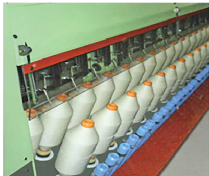
1-расм. Ғалтак новини оғдириб қўлда съёмга тайёрлаш
