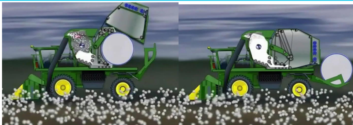
5-расм. Машина комбайнида тайёрланган пахта модулини чиқариш жараёни
