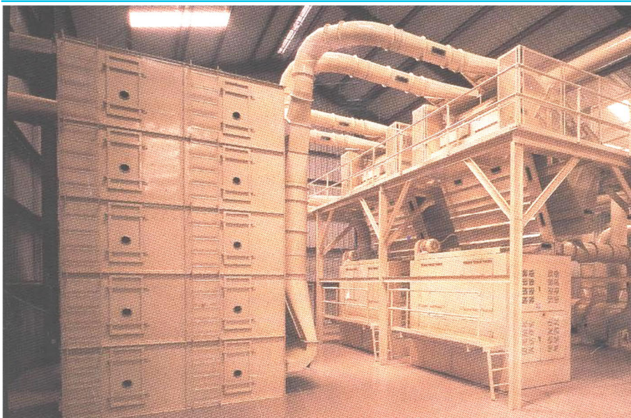
2- расм. Чигитли пахтани қуритиш ва тозалаш ускуналарининг умумий кўриниши
