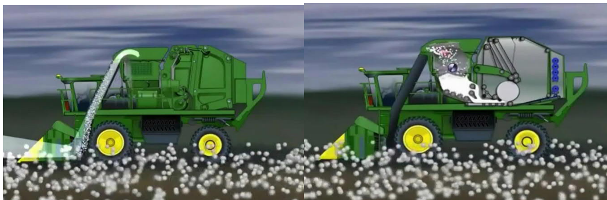
3-расм. Машина комбайнида пахтани биринчи секциядан иккинчи секцияга ўтиш жараёни
