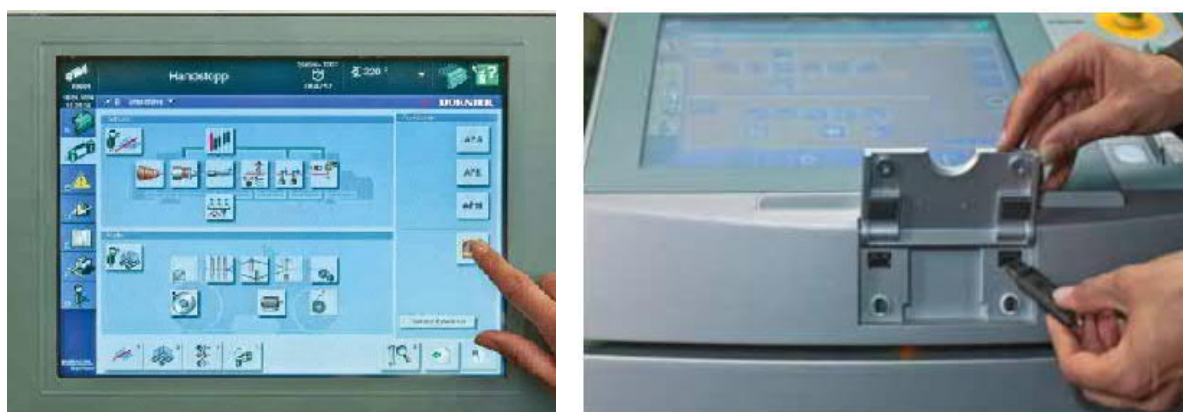
2-расм. Совет а) ва Dornier б) тўқув дастгоҳларини электрон назорат панели
