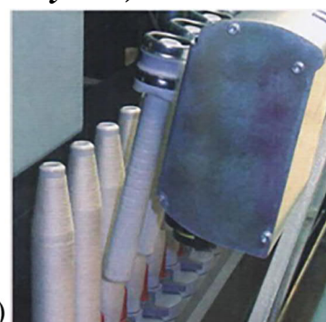
7-расм. SERVOгrip қурилмаси а) ва ROBOdoff съём тизими б)
