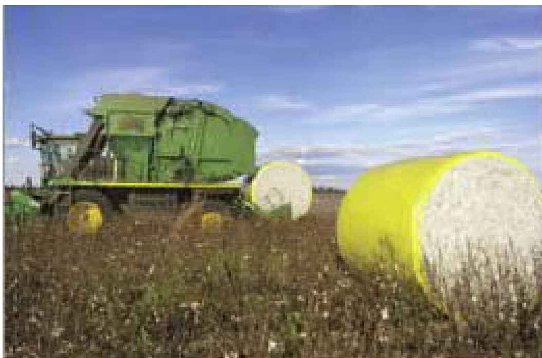
8-расм. СР690 русумли пахта териш комбайни ва ундан пахтани модуль чиқариш жараёни
