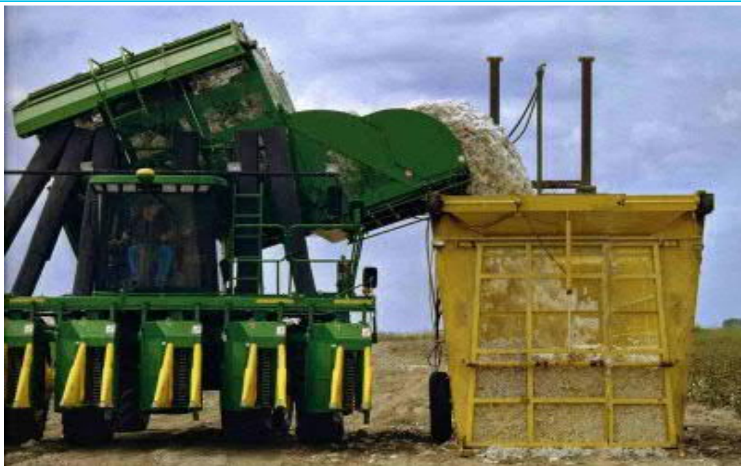
7-расм. Пахта териш комбайни ва ундан пахтани модуль тайёрлагичга юклаш жараёни
