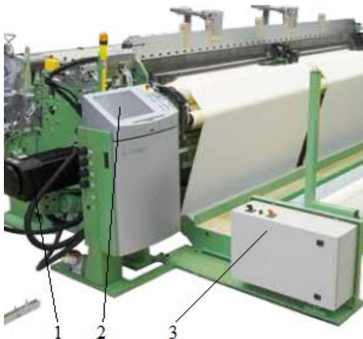
5-расм. DORNIER тўқув дастгоҳи 1- DORNIER SyncroDrive мотори, 2-бошқарув панели, 3-электрокути.
