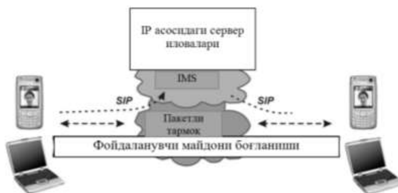
3.3-расм. Пакетлар коммутацияланадиган тармоқларда IMS тизимининг роли
