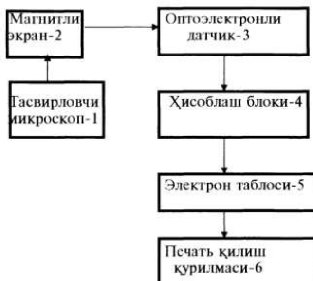
I.16-rasm. "Reyxart" (Avstriya) firmasining MOA-AMG'3 optik analizatori bilan qurilmaning blok-sxemasi.
