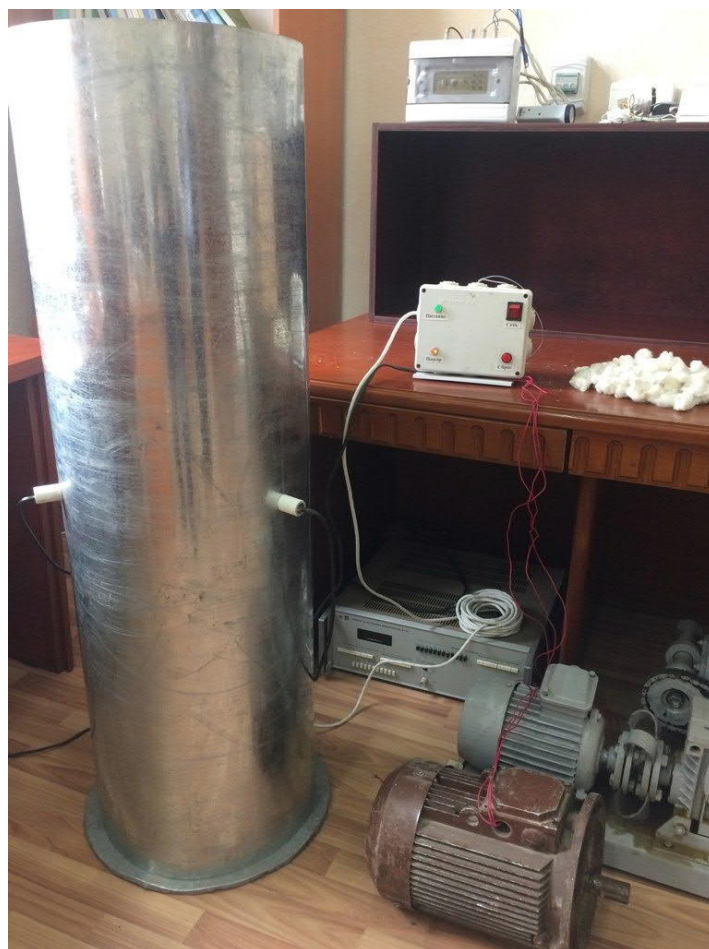
3.7-расм. Ёнғинни автоматик аниқлаш қурилмасининг стенд нусхаси.
