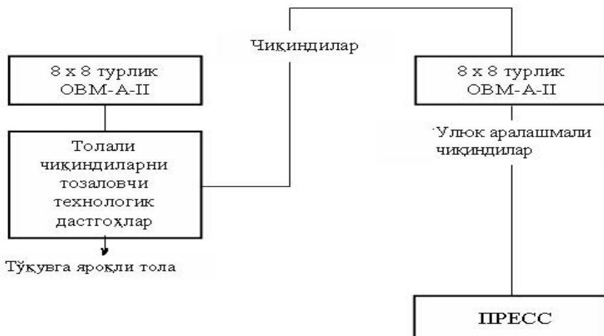
15-расм. Толали чиқиндиларни тозалашнинг технологик схемаси
