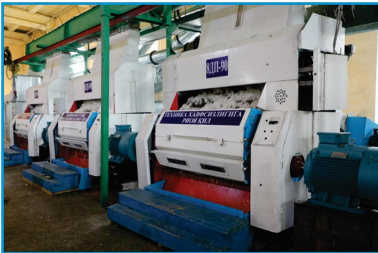
3.4-расм. 8ДП-90 русумли аррали жин ускунасининг умумий кўриниши
