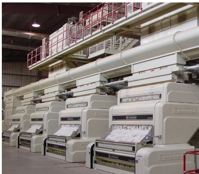
4.2-расм. Аррали жинлар ўрнатилган қаторнинг умумий кўриниши
